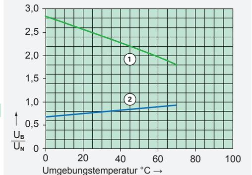
1) Max. Erregerspannung mit Kontaktbelastung: ≤4 A
