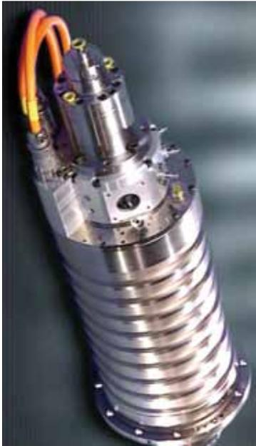
Die inkrementelle Erfassung von Drehbewegungen geschieht berührunglos durch Abtasten eines ferromagnetischen Messzahnades. Aufgrund der hohen Fertigungstiefe im Hause Lenord + Bauer kann für nahezu jede Applikation im Bereich der Werkzeugmaschinen die passende Maßverkörperung konstruiert und angefertigt werden.
