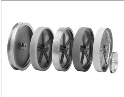
Damit beim Antrieb über Messräder das Messergebnis nicht verfälscht wird, ist darauf zu achten, dass der Schlupf möglichst gering bleibt. Bei der Auswahl des Profils (Oberfläche) ist die Beschaffenheit des Messgutes, dessen Dehnbarkeit, Dicke und Mitnahmewiderstand zu berücksichtigen.
