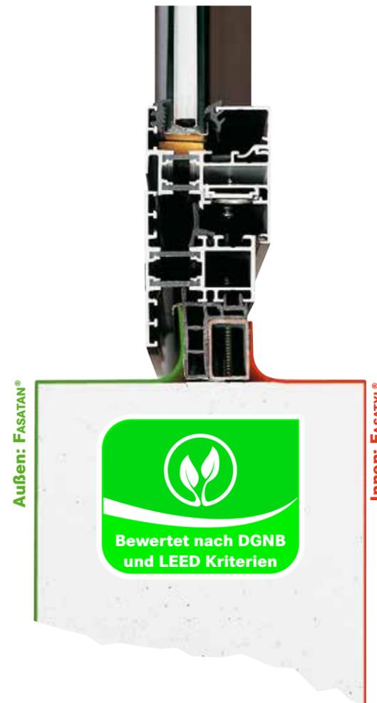
**Fasatan®** (dampfdiffusionsoffen, für außen) und **Fasatyl®** (dampfdiffusionsdicht, für innen).
